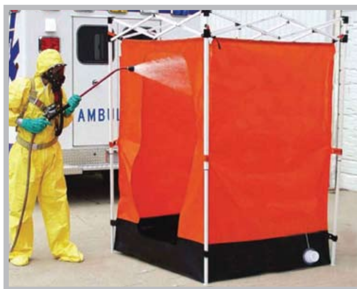
Duchas de descontaminación.
