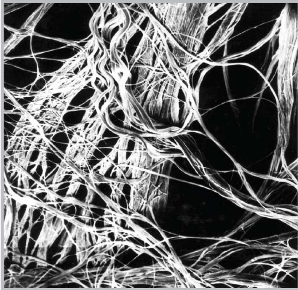
Fibras de Amianto.
